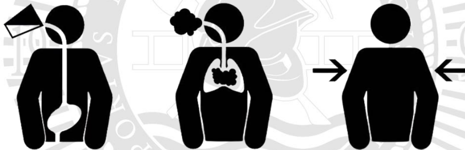
Imagen 28.- Vías principales de acceso de químicos a nuestro organismo. Ingestión, inhalación y absorción cutánea.
