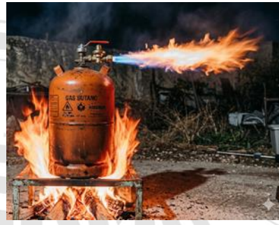
Dardo creciente, por aumento de presión interna del envase, por elevación persistente de T^a .
